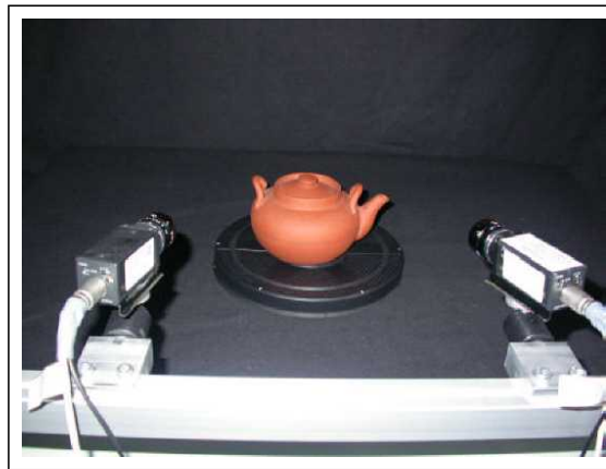
(10) Automatico. Sistema stereoscopico di acquisizione.
