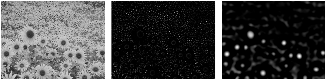
Figura E.39. – Immagine di prova e risposta del laplaciano di gaussiana con \sqrt{s} = 3 e \sqrt{s} = 15 . Come si vede i picchi della risposta corrispondono alle macchie scure di una certa dimensione, che dipende dalla s
