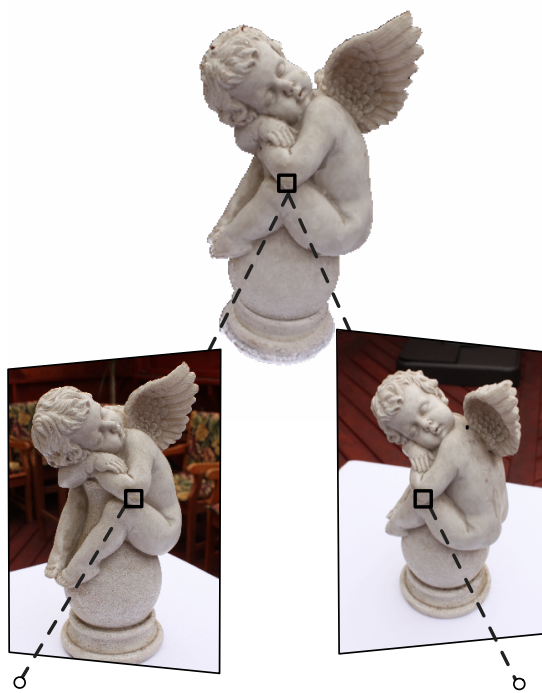
Figura E.16. – Coppia stereo. Due punti coniugati nelle immagini sono la proiezione del medesimo punto dello spazio
