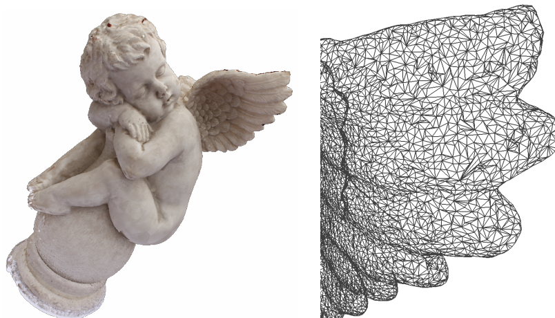
Figura E.88. – Resa grafica del modello 3D del cherubino. Si tratta di una maglia poligonale con colori associati ai vertici. Il dettaglio di destra mostra chiaramente la struttura della maglia
