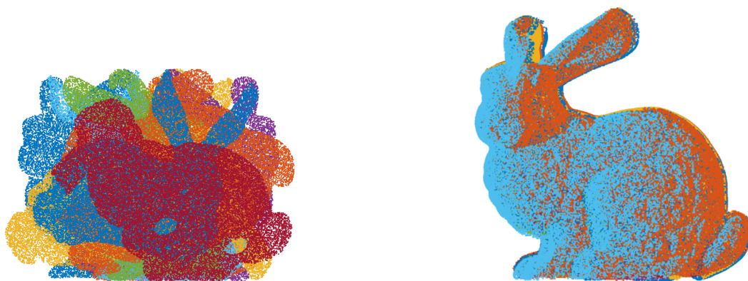
Figura E.78. – Registrazione. A destra, otto immagini range di un oggetto ognuna nel proprio sistema di riferimento. A sinistra, tutte le immagini sovrapposte dopo la registrazione. Per cortesia di F. Arrigoni
