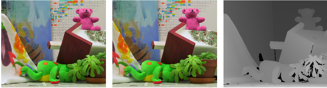
Figura E.48. – Coppia di immagini stereo e mappa di disparità ideale (immagini prese da http://vision.middlebury.edu/stereo/ )
