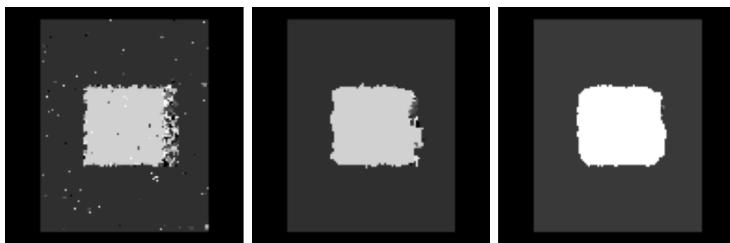
Figura E.54. – Mappe di disparità ottenute con la correlazione SSD su uno stereogramma a punti casuali con rumore gaussiano \sigma^2 = 10.0 aggiunto. Il livello di grigio – normalizzato – rappresenta la disparità. La dimensione della finestra di correlazione vale, da sinistra a destra, 3x3, 7x7 e 11x11
