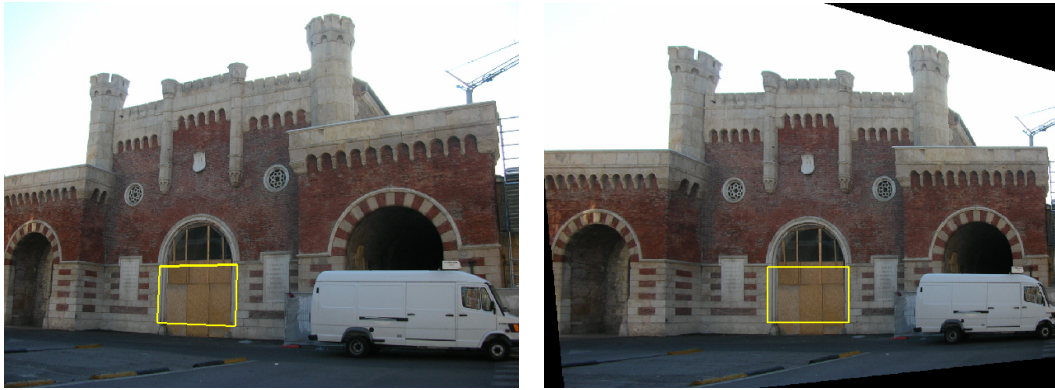
Figura E.97. – A destra una fotografia di scorcio di Porta Vescovo (Verona). A sinistra il fotopiano della facciata centrale
