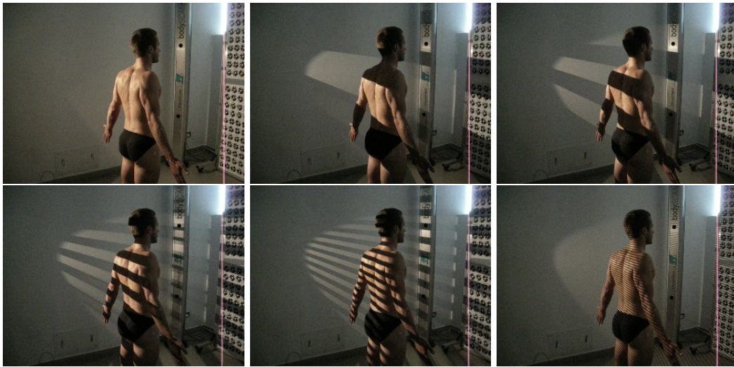
Figura E.65. – Luce codificata. Alcune immagini di un soggetto con bande di luce proiettate. Nell'immagine in basso a destra le bande sono molto sottili e non sono visibili a risoluzione ridotta. Per cortesia di A. Giachetti
