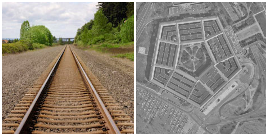
Figura E.3. – L'immagine a sinistra è decisamente prospettica – si notino le linee convergenti – mentre l'immagine aerea di destra è decisamente ortografica – la distanza dall'oggetto è sicuramente molto grande rispetto alla sua profondità
