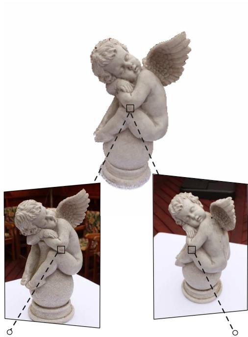
*Figura 15. – Coppia stereo. Due punti coniugati nelle immagini sono la proiezione del medesimo punto dello spazio*
