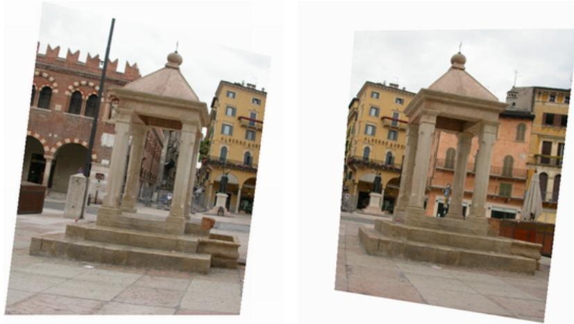
*Figura 22. – Coppia stereo rettificata (la coppia originale è mostrata in figura 19)*
