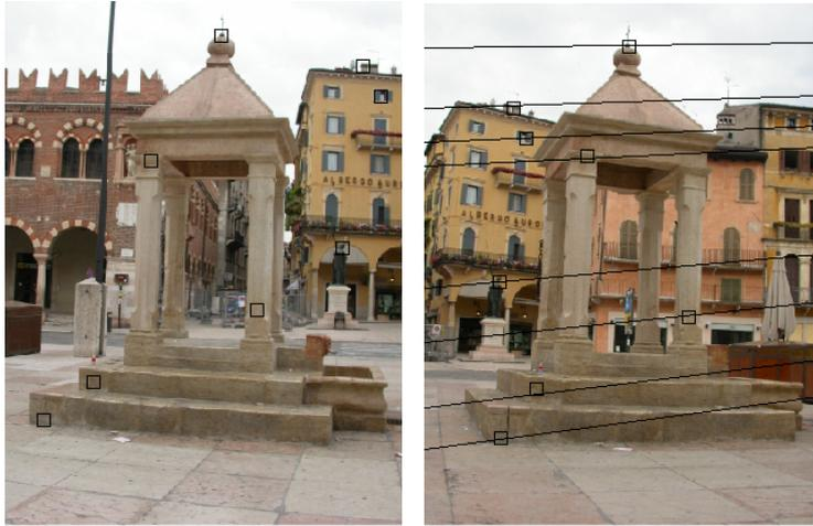
*Figura 19. – Coppia stereo. A destra sono disegnate le rette epipolari corrispondenti ai punti marcati con un quadrato nell'immagine sinistra*
