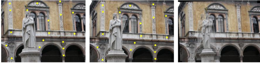
*Figura 30. – Le prime due immagini da sinistra sono le originali. La terza è la sovrapposizione della seconda con la prima trasformata secondo l'omografia del piano della facciata del palazzo (i punti usati per il calcolo dell'omografia sono evidenziati)*
