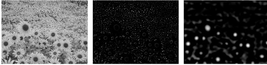
*Figura 40. – Immagine di prova e risposta del laplaciano di gaussiana con  $\sqrt{s} = 3$  e  $\sqrt{s} = 15$ . Come si vede i picchi della risposta corrispondono alle macchie scure di una certa dimensione, che dipende dalla  $s$*
