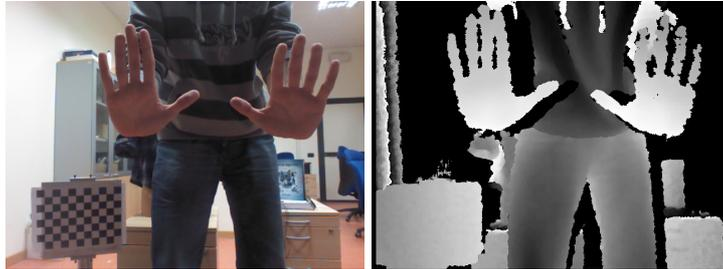
*Figura 101. – Immagine di colore ed immagine range dello stesso soggetto, catturate da un dispositivo Kinect (©Microsoft). Per cortesia di U. Castellani*
