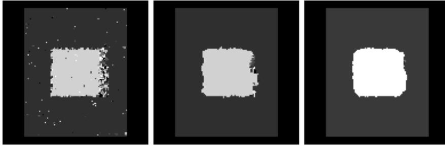
Figura 50. – Mappe di disparità ottenute con la correlazione SSD su uno stereogramma a punti casuali con rumore gaussiano  $\sigma^2 = 10.0$  aggiunto. Il livello di grigio – normalizzato – rappresenta la disparità. La dimensione della finestra di correlazione vale, da sinistra a destra, 3x3, 7x7 e 11x11
