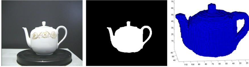
Figura 82. – Immagine di una teiera sul piatto rotante e relativa sagoma. Ricostruzione volumetrica ottenuta con 12 sagome (i voxel sono rappresentati da sfere)
