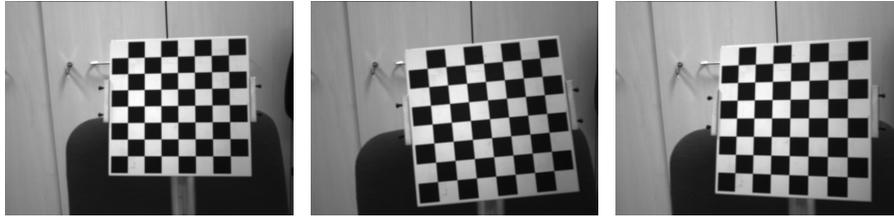
*Figura 31. – Alcune immagini della scacchiera di calibrazione*
