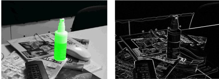
*Figura 32. – Esempio di applicazione del metodo diretto. La bottiglietta spray è l'oggetto di cui è noto il modello. A destra la mappa di gradiente sulla quale si basa il recupero dell'orientamento della fotocamera*
